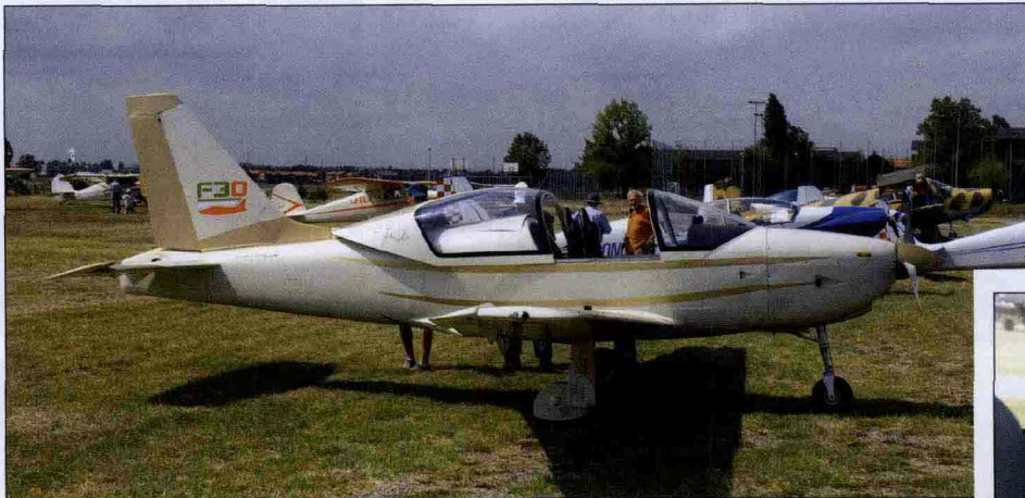
A sinistra: interessante novità vista a Ferrara è stato l'F30, un ultraleggero disegnato da Stelio Frati e costruito (per adesso in tre esemplari) dalla Golden Car di Cuneo. Biposto in alluminio con carrello retrattile, l'ULM è spinto da un Rotax 912S da 100 hp (ma saranno disponibili motorizzazioni più potenti, fino a 200 hp) ed ha una velocità massima di 300 km/h. Sotto: il cockpit dell'aereo.
